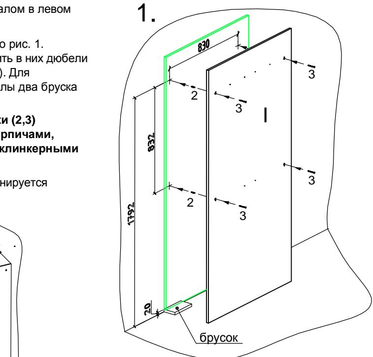
Нарезать двухсторонний скотч (1) на равные части по 150 мм. Разметить положение отрезков скотча (1) на панели (I). Снять защитную пленку с одной стороны скотча и приkleпить его к панели согласно разметки (рис. 2).
