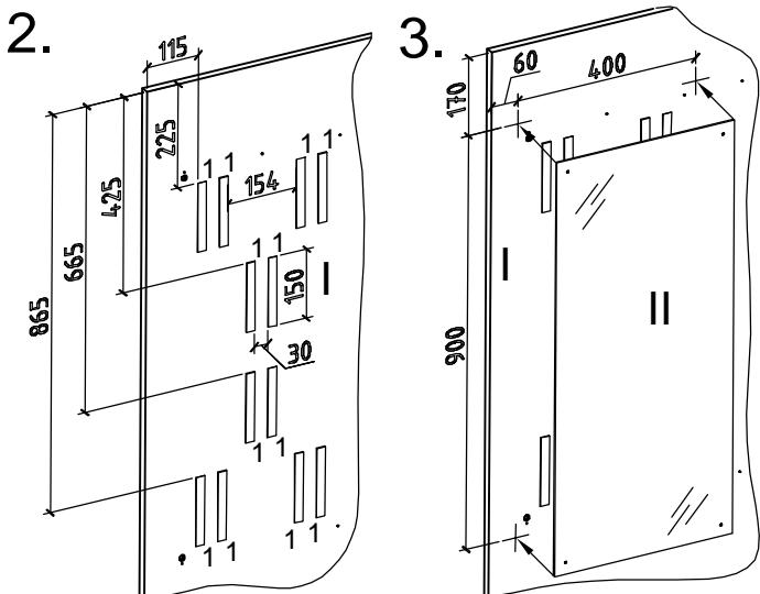
Разметить положение зеркала (II) на панели (I). Снять защитную пленку со второй стороны скотча (1) и аккуратно прижать зеркало (II) к панели (I), согласно разметки (рис. 3).
