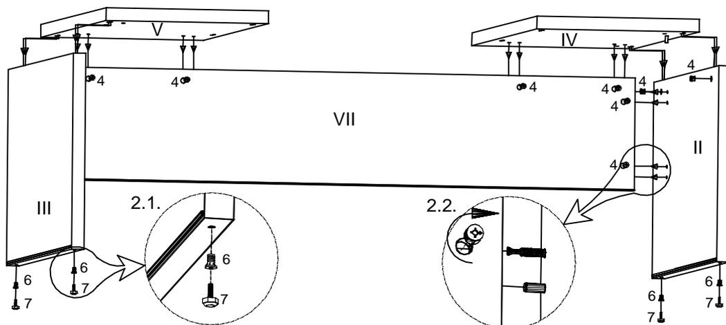
В торцевые отверстия правой и левой боковин (II и III) забить втулки (6). Вкрутить во втулки регулируемые опоры (7) (рис.2.1).
